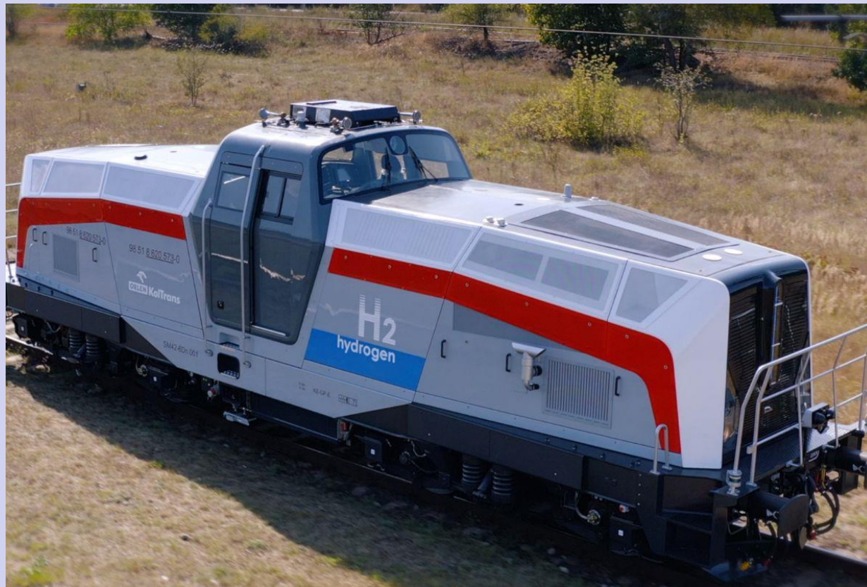
Lokomotywa manewrowa DM42- 6Dn Hydrogen zasilana wodorem z firmy PESA
