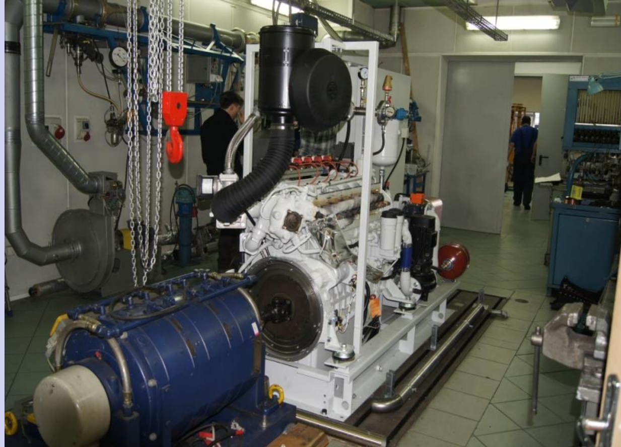
Zmodyfikowany 6-cylindrowy silnik MAN zasilany wodorem podczas badań w laboratorium Politechniki Krakowskiej
